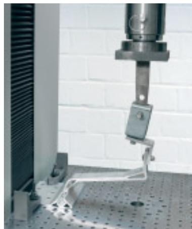
Patte d'ancrage de toit, tuile 3 Al
