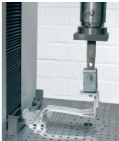
Patte d'ancrage de toit, tuile 3 Al
