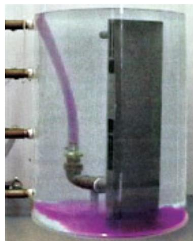
Le retour froid du chauffage s'écoule en partie basse du réservoir.
